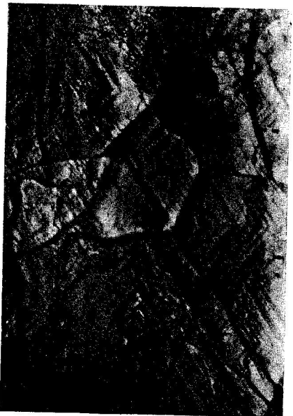
Obr. 6. Snímka získaná z roviny (101) Langovou transmisnou metódou ukazujúca domény prebiehajúce cez hranice mozaikových blokov, 50 X.
