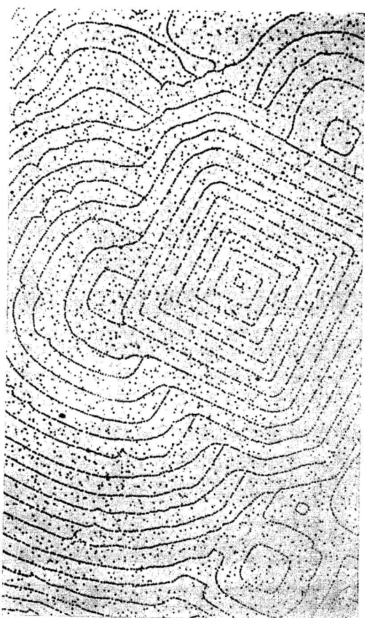
Obr. 1. Odparové štruktúry nedotovaného kryštálu NaCl. Odparovacie podmienky: vysoké vákuum, 475 °C, 30 min. Dekorácia zlatom, zväčšenie 25 000 ×.
